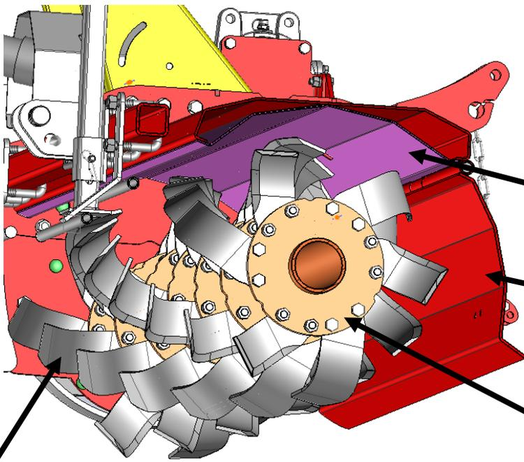
Châssis renforcé par 2 tôles intérieures en acier de blindage
